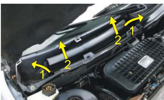
(PL) Odpiąć klipsy zabezpieczające, wyciągnąć gniazdo filtra
